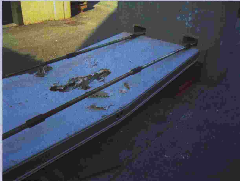
Fotografia del campione rotto con la mazza dopo l'esecuzione della prova (secondo la richiesta del Committente).
